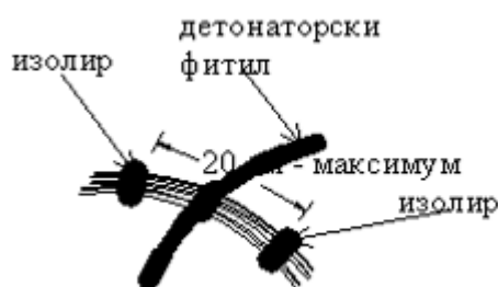
Слика 2. Начин на поврзување на нонел системот за иницирање со детонаторскиот фитил Figure 2. Way of connecting the initiation non-el system with the detonating cord
