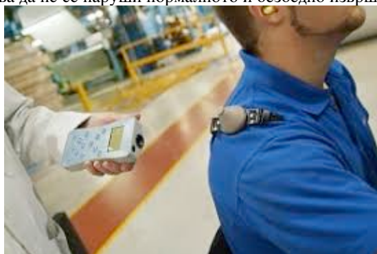
Слика 1. Локација на микрофонот при одредување на персонална изложеност на бучава Figure 1. Microphone location during personal noise exposure measurement
