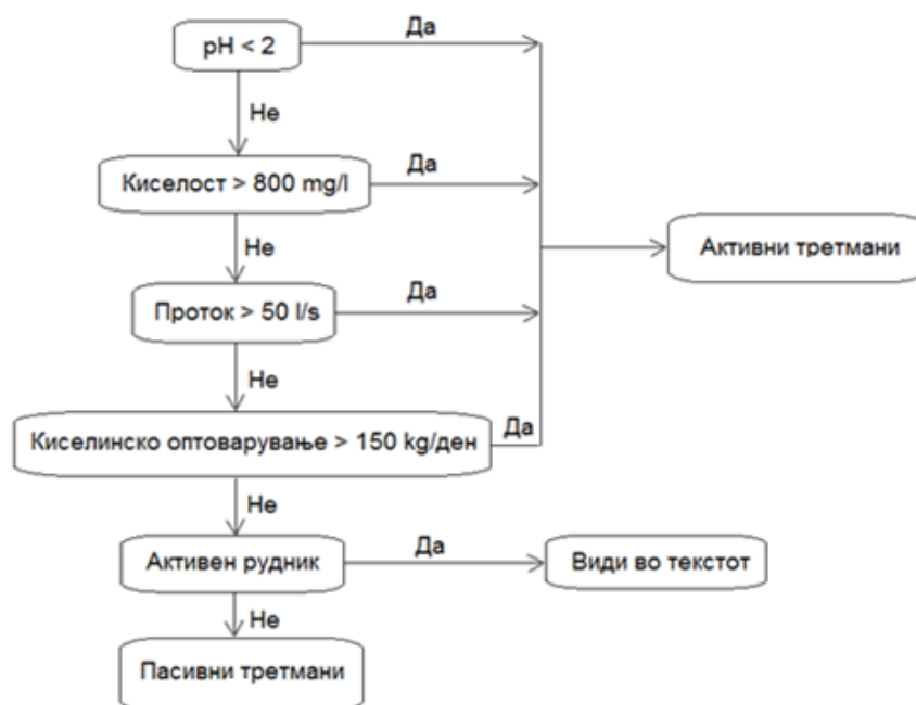
Слика 1.: Шема за избор меѓу активен и пасивен третман на кисели руднички дренажи. Киселинското оптоварување е пресметано како киселост (mg CaCO 3 /l) x проток (l/s) x 0.0864 Figure 1.: Scheme choice between active and passive treatment of acid mine drainage
