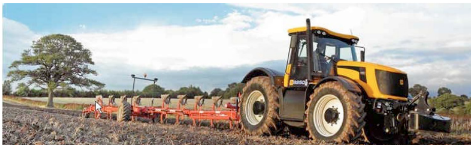
Сл. 7. JCB FastTrac 8250, модел на трактор со брзина на движење до 70 km/h и систем за кочење ABS (Anti-lock Breaking System), JCB (2006)
