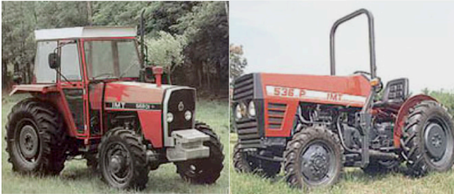
Сл. 2. Кабина и заштитна рамка за зголемување на безбедноста при работа (20)
